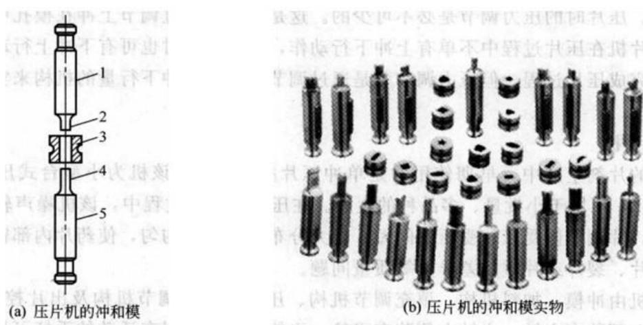
图 4-2 压片机的冲头和模圈
