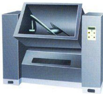
图 3-6 槽型混合机示意图
