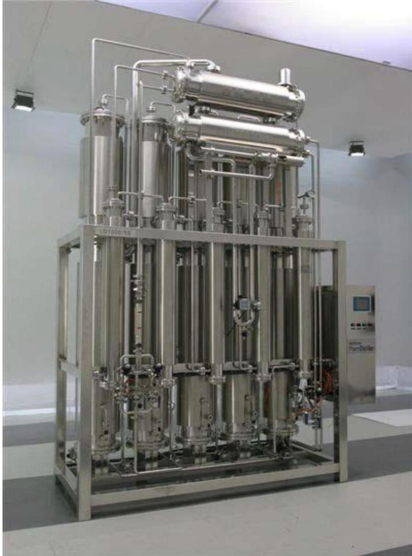
图 3-11 多效蒸馏水器
